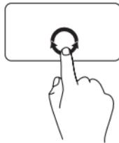
Mueva el dedo en la zona de desplazamiento horizontal (parte inferior de la superficie táctil), con un movimiento circular en el sentido de las manecillas del reloj para desplazarse a la derecha o en el sentido inverso para desplazarse a la izquierda.
