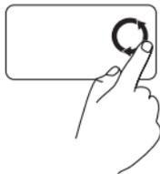
Mueva el dedo en la zona de desplazamiento vertical (lado derecho de la superficie táctil), con un movimiento circular en el sentido de las manecillas del reloj para subir o en el sentido inverso para bajar.
